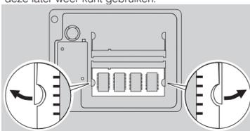
8 Breng de uitsparing in de contactrand van de SO-DIMM op lijn met de splitser in de uitsparing. Druk de SO-DIMM in een hoek van 20 graden stevig in de aansluiting **1** en kantel de module naar beneden, zodat de module vastklikt **2**.
