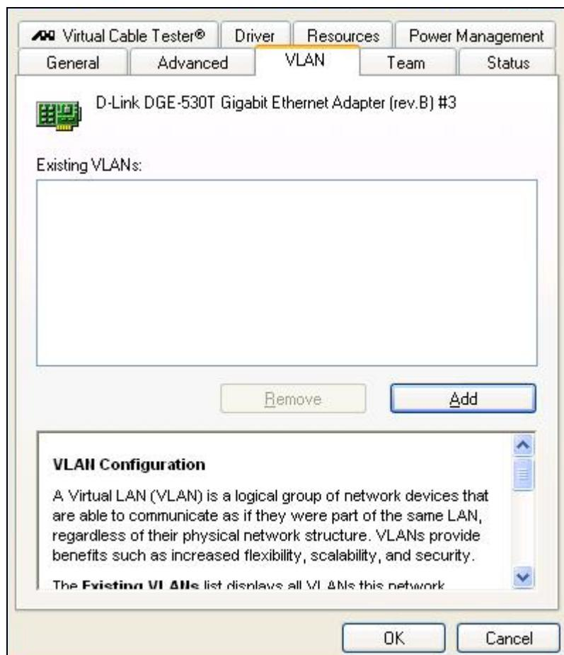
Pour ajouter un paramètre VLAN à cette fenêtre, cliquez sur le bouton **Add (Ajouter)** au bas de la fenêtre, ce qui ouvrira la fenêtre de configuration suivante.
