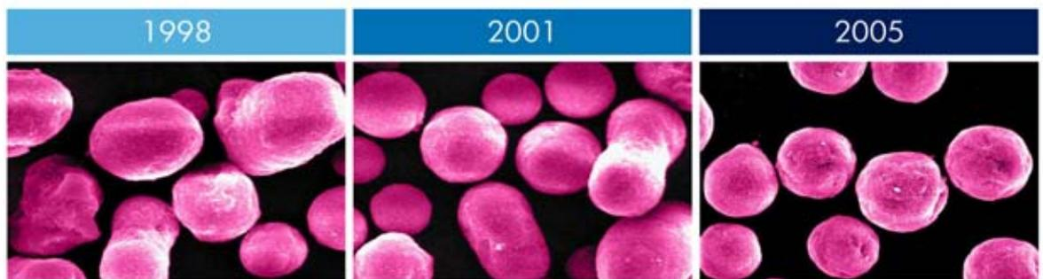
El control preciso de carga de las partículas de tóner también depende en parte de los aditivos en la superficie. Las partículas con una cantidad consistente de aditivos en relación con su masa total y una forma esférica consistente, permitirán un control de carga mucho mayor y, por lo tanto, permitirán una impresión de mayor calidad.
